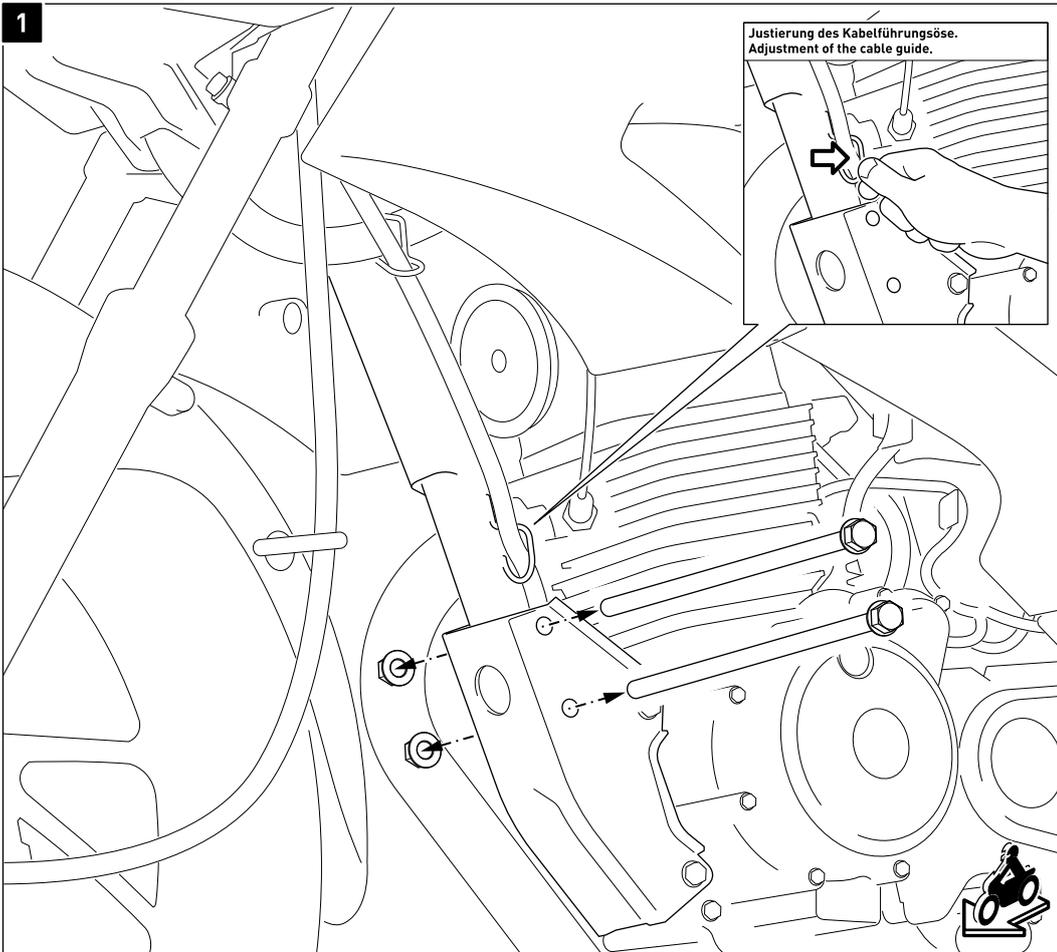
Entfernen Sie die gezeigten originalen Schrauben und Muttern vom Fahrzeug.
