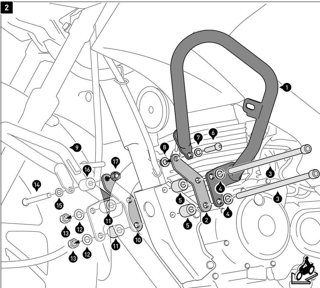
Verschrauben Sie die Schutzbügel (1) und (9) am Fahrzeug, wie in der Zeichnung gezeigt. Beachten Sie dabei die asynchrone Anordnung der Anbauteile.
